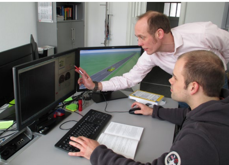
Simulation einer Fahrt auf einer generierten Strecke zur Bestimmung des Energieverbrauchs.
