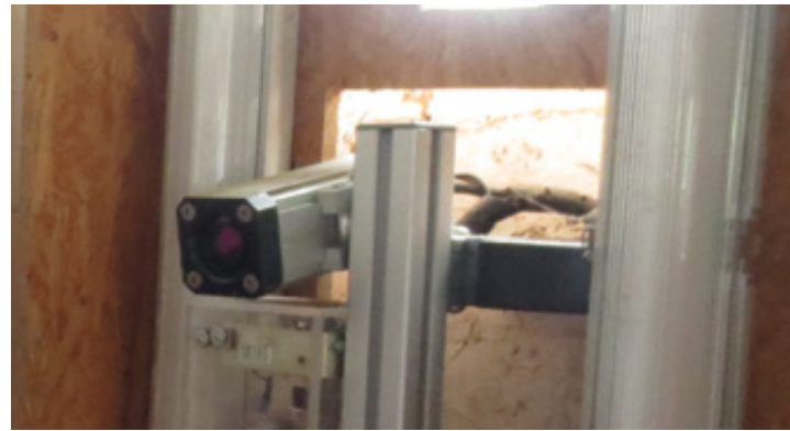
Die Kamera filmt die Pferde, wenn sie den Stall betreten, und erkennt, wie viel Futter ihnen jeweils zusteht – ein großer Fortschritt gegenüber bisherigen Methoden der Futterrationierung.
